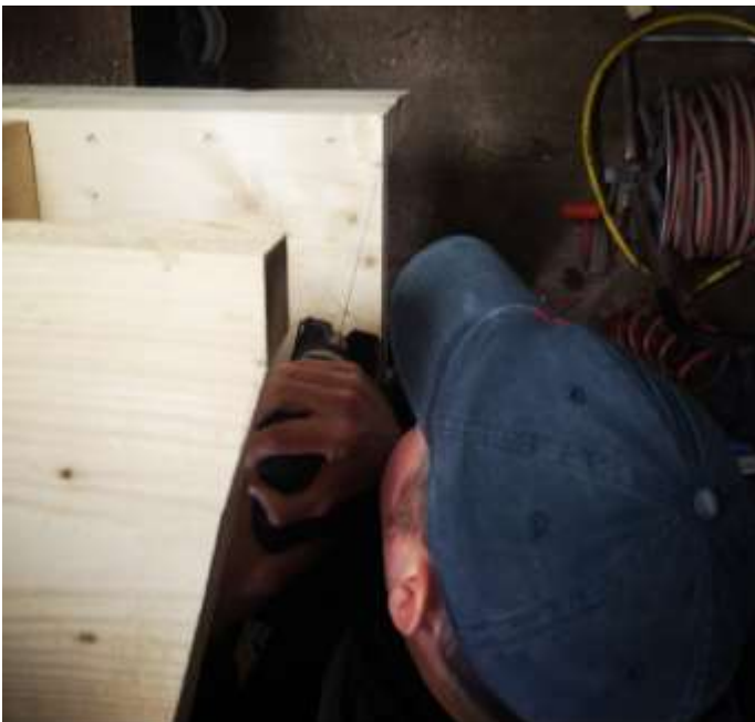
Abbildung 9: Absägen entlang der Hilfslinie mit der Stichsäge
