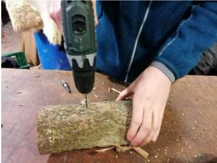
Abbildung 13: Mit dem Akkuschauber und Bohraufsätzen verschiedener Größe werden Löcher radial gebohrt
