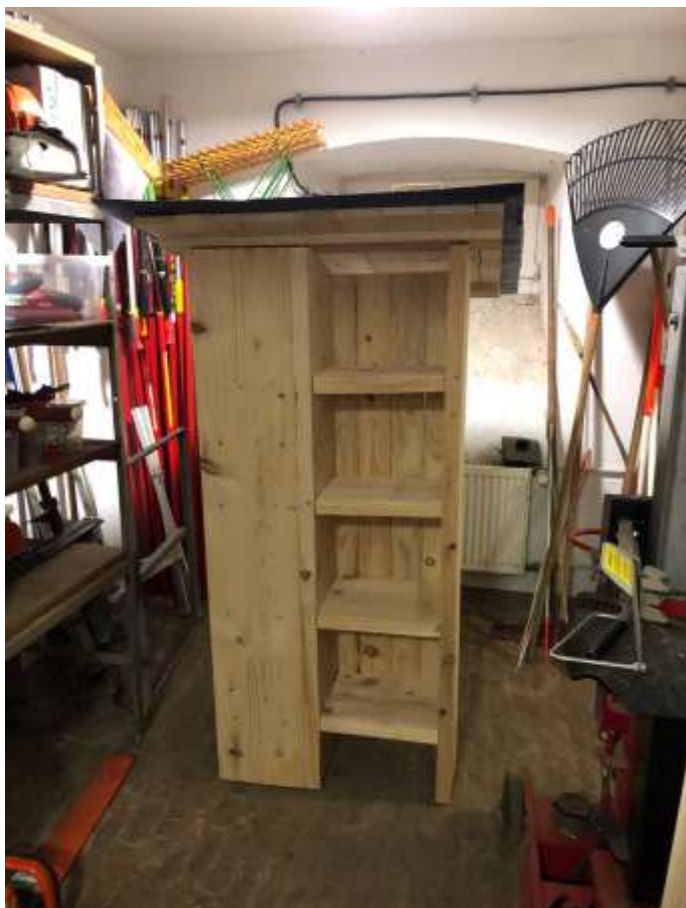
Abbildung 12: Fertige Wildbienennisthilfe mit auf dem Dach befestigter Dachpappe
