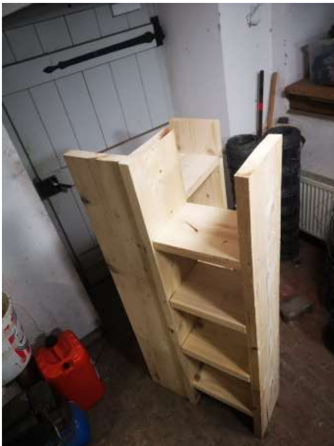
Abbildung 6: Verbindung von Hauptkorpus und Nebenkorpus
