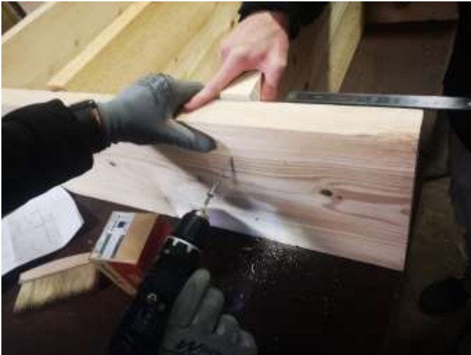
Abbildung 3: Verschraubung der Seitenwand mit den Regalbrettern
