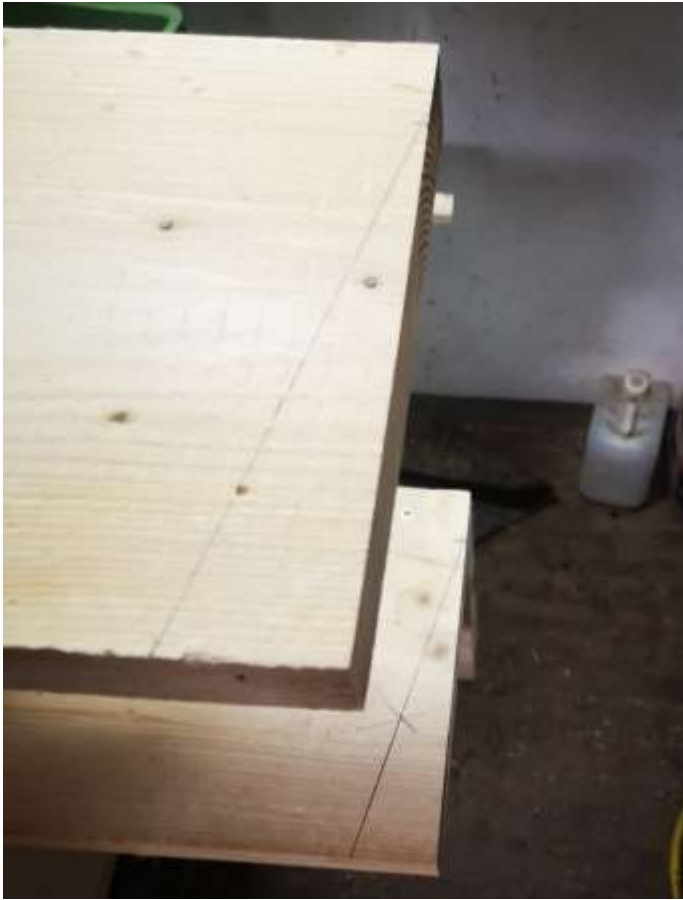
Abbildung 8: Mit Bleistift angezeichnete Hilfslinien
