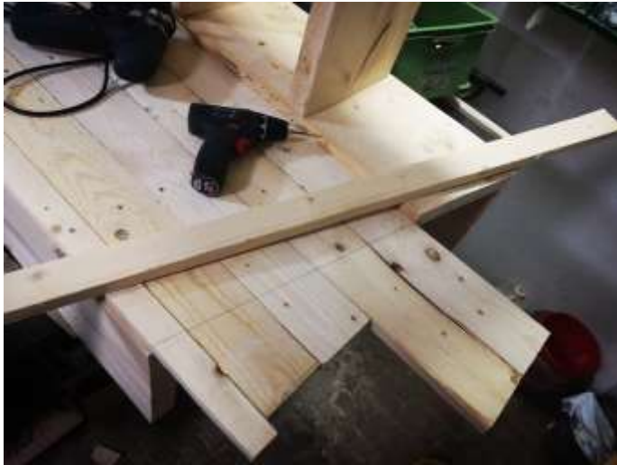
Abbildung 10: Anbringung der Rückwände und anschließende Anzeichnung der Hilfslinie für die Dachschräge. Danach wurde mit der Stichsäge entlang der Hilfslinie gesägt.
